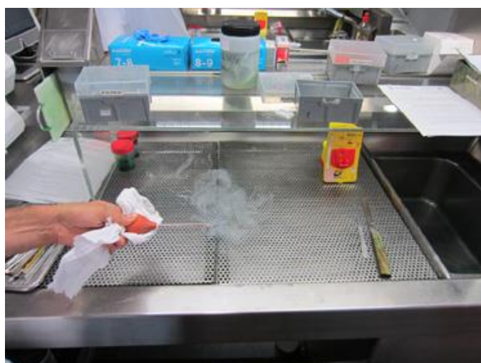
Imagen 3. Prueba de comprobación del flujo del aire en una de las mesas centrales.
